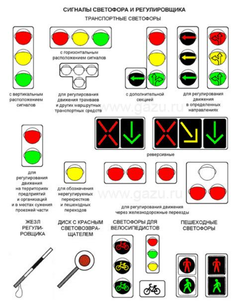
3.1. В светофорах применяются световые сигналы зеленого, желтого, красного и белолунного цвета. В зависимости от назначения сигналы светофора могут быть круглые, в виде стрелки (стрелок), силуэта пешехода или велосипеда и Хобразные. Светофоры с круглыми сигналами могут иметь одну или две дополнительные секции с сигналами в виде зеленой стрелки (стрелок), которые располагаются на уровне зеленого круглого сигнала.
